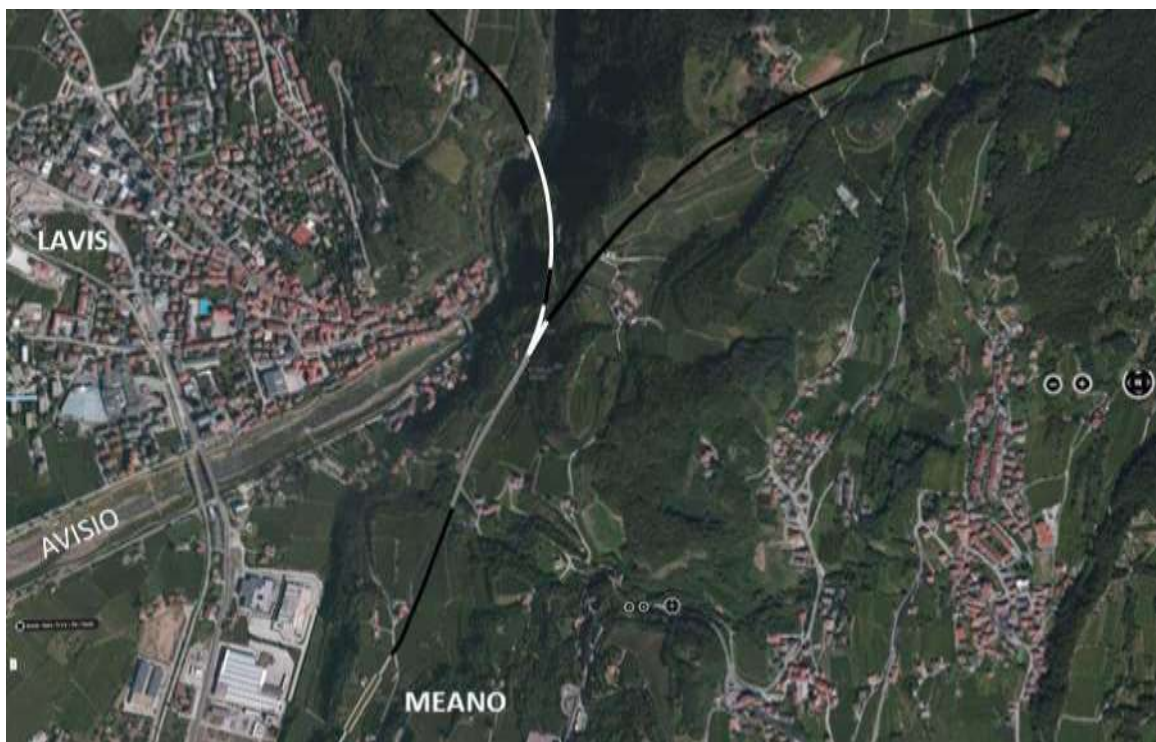
Fig. 6 - Val di Cembra: inizio di due possibili tracciati ferroviari alternativi
